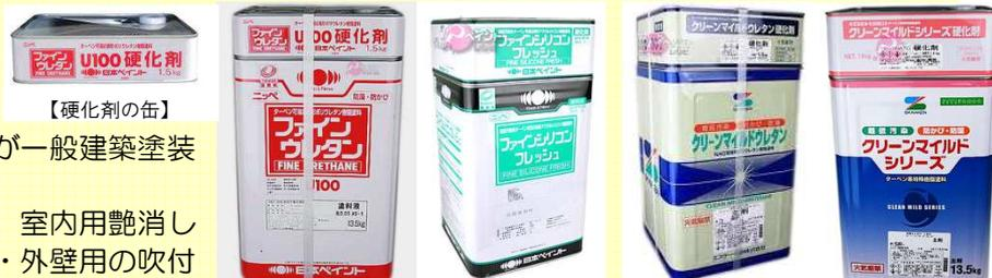
【代表的な二液型塗料】左が日本ペイント、右がエスケー化研のウレタン系とシリコン系の塗料。商品名に「二液」の表示は無く、どれも主剤缶の上に平べったい硬化剤の缶が載っています。油性なので、鉄部・木部・外壁のどこにでも塗れるが、エスケー化研の塗料は外壁に適し、鉄部・木部には関西ペイントのものが適していて、日本ペイントはその中間になっている。
